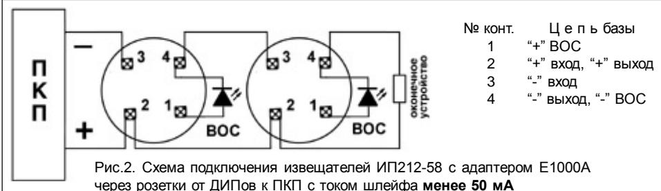
Рис.2. Схема подключения извещателей ИП212-58 с адаптером Е1000A
