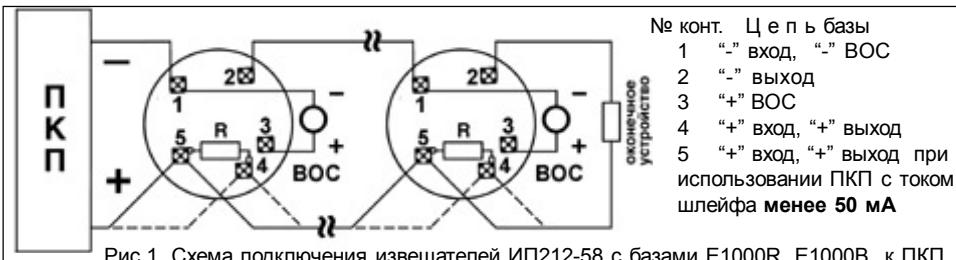
Рис.1. Схема подключения извещателей ИП212-58 с базами Е1000R, Е1000B к ПКП.
