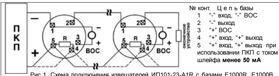
Рис.1. Схема подключения извещателей ИП101-23-А1Р с базами Е1000Р, Е1000В к ПКП. В базе Е1000В резистор и 4-й контакт не установлен.
