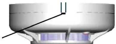
Рис. 5. Извлечение извещателя из базы
