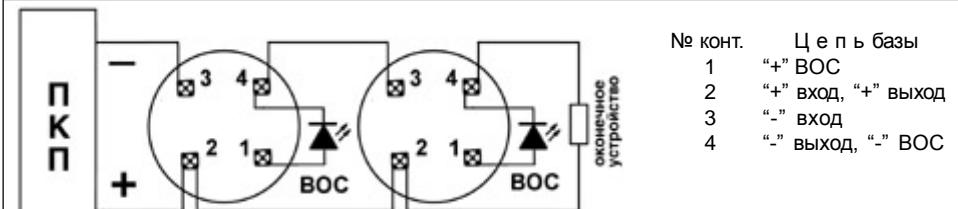
Рис.2. Схема подключения извещателей ИП101-23-А1Р с адаптером Е1000А через розетки от ДИПов к ПКП с током шлейфа **менее 50 мА**
